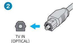
Quando não existe entrada HDMI IN identificada como "ARC" no televisor, utilize o cabo digital ótico (fornecido) para ligar uma tomada de saída ótica no televisor e a entrada TV IN (OPTICAL) no Sound Bar.
