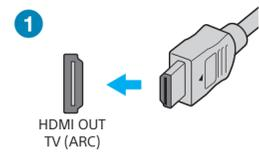
Utilize um cabo HDMI (não fornecido) para ligar uma tomada HDMI IN no televisor e a tomada HDMI OUT (TV [ARC]) no Sound Bar.
