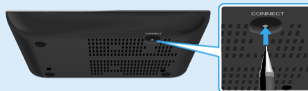
Utilize um objecto fino e pontiagudo, como a ponta de uma caneta, para carregar no botão CONNECT.
