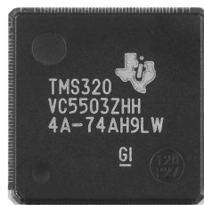
DSP utilizzato nel modello MDR-NC500D
