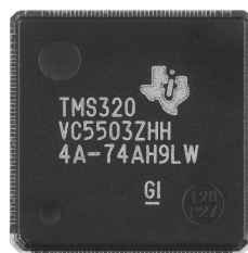
DSP utilisé dans le MDR-NC500D
